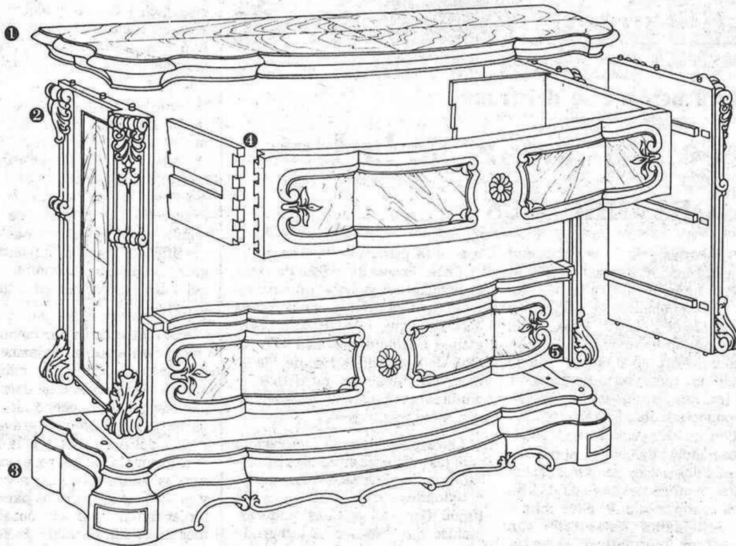
4 Ensamblés del tipo «cola de milano», ejecutados a la manera tradicional en ebanistería, para proporcionar la máxima solidez al conjunto.
