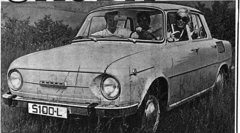
SKODA 100 L - Características principales: cilindrada: 988 c. c. frenos hidráulicos, delanteros de disco y traseros de tambor. carrocería autoportante velocidad: 130 Kms. hora consumo: 7 litros por 100 Km.
