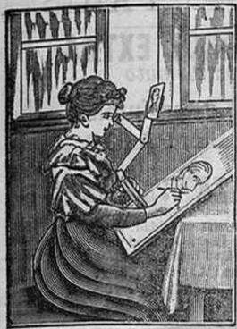
El *dicatóptero* forma, en su estado compuesto y ejecución actual, una cajita de 22 centímetros próximamente de longitud, 19 centímetros de latitud y 4 centímetros de altura, con peso de cerca  $\frac{3}{4}$  de kilogramos; puede ser conducido como un libro, y para su empleo en el campo para dibujos de paisaje, se emplea un soporte de 80 centímetros de longitud y  $\frac{3}{4}$  kilogramos peso.
