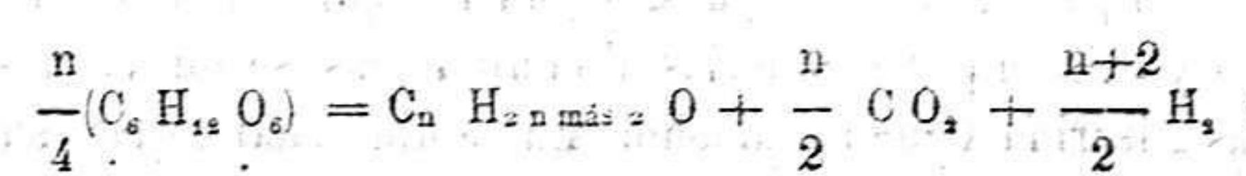
En resumen: la materia fermentescible (azúcar) se transforma bajo la acción de la levadura de cerveza en los siguientes productos enumerados, según su importancia: alcohol etílico, anhídrido carbónico, glicerina, ácido succínico, ácido acético, aldehido y alcoholes homólogos superiores al etílico.
