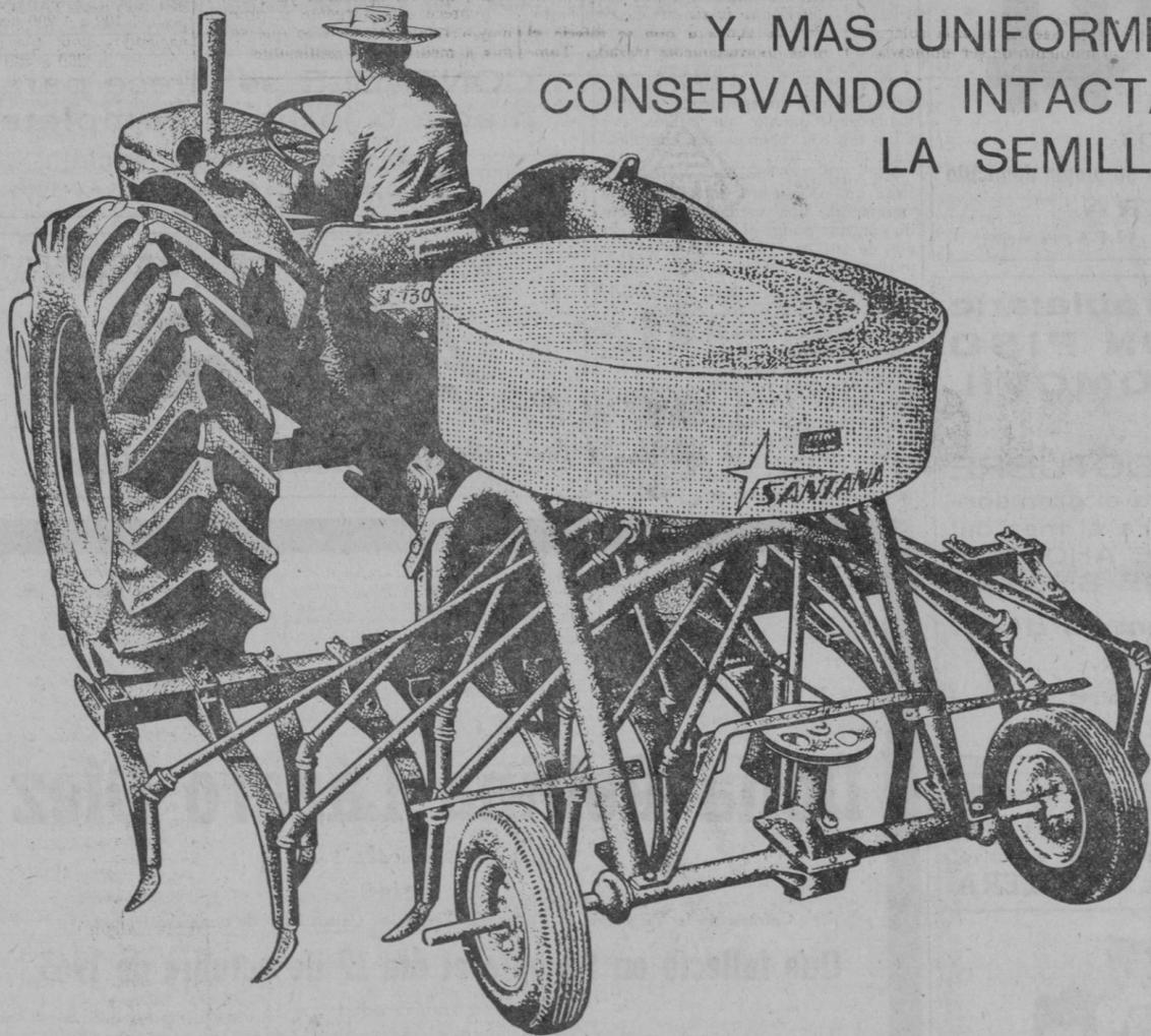
El sistema centrífugo de la sembradora SANTANA permite que la semilla se deposite uniformemente asegurando una perfecta distribución. La sembradora centrífuga SANTANA está especialmente concebida para sembrar toda clase de semillas.
