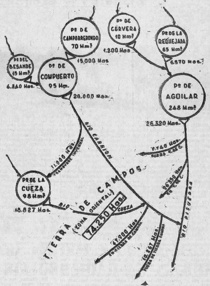
Esquema hidraulico del sistema Pisuerga-Carrion, en el que son invertidas en el plan de inversiones para cuatro años 1.096.162.225 pesetas.
