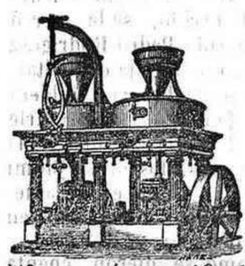
Máquinas harineras de motores hidráulicos y de vapor
